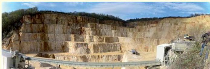
Abb. 2: Zu den Besonderheiten der Region gehören die mächtigen Kalksteinlagerstätten, die auch große Körper mit Kalken von > 99% CaCO<sub>3</sub> enthalten, welche für industrielle Einsatzbereiche (Papier, Glas, Pharmazie, Farben usw.) geeignet sind. Fotobeispiel: Stbr. Blaustein-Wippingen (RG 7525-9).
